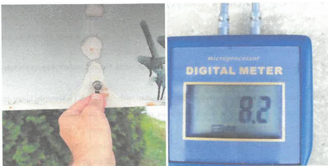
Fotografia nr 2 i nr 3 Pomiar grubości środnika ceownika i jego wynik w miejscu ubytku powłoki malarskiej
